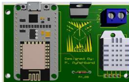
شکل (۴): بردهای سخت‌افزاری تولید شده از طریق آینه‌بند و همکاران جهت به‌کارگیری در سیستم تشخیص وقایع مبتنی بر شبکه اجتماعی اینترنت اشیاء [۲]
