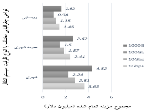
شکل (۴): قیمت تمام شده در انواع سیستم انتقال در نواحی مختلف
