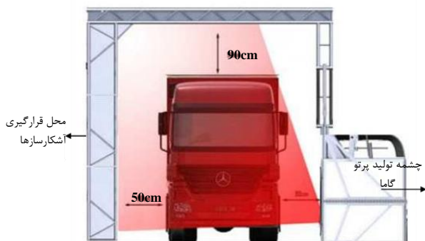
شکل (۳): نمای سازه مکانیکی سامانه
