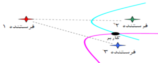
شکل (۱). مکان گیرنده لورن در فصل مشترک خطوط مکان‌یاب هذلولوی است.
